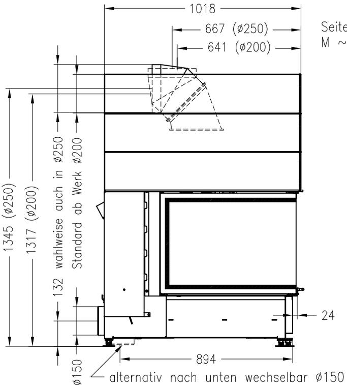
ACHTUNG: Gerät geprüft mit Abgasdurchmesser  $\varnothing 200$ , alternativ auch mit  $\varnothing 250$  erhältlich!
